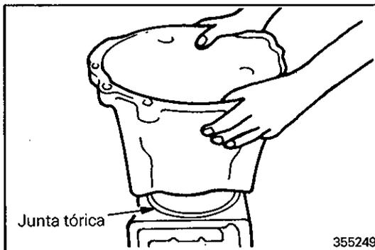
(26) Instalar la junta tórica en la posición indicada en la ilustración y colocar luego la carcasa del convertor.
