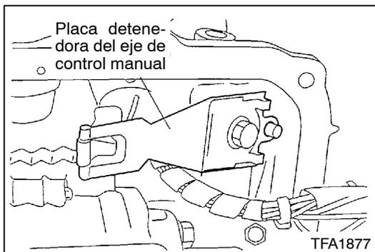
Instalar la placa detenedora del eje de control manual <Modelos 1997>
