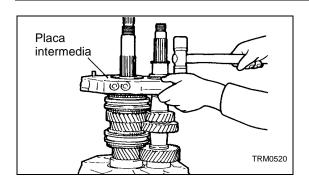
(2) Utilizando un martillo de plástico, instalar la placa intermedia.
