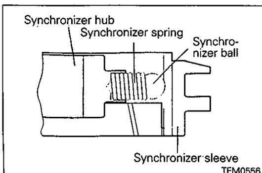
**REASSEMBLY SERVICE POINTS****◆A◆ SYNCHRONIZER SPRING / BALL / SLEEVE INSTALLATION**
