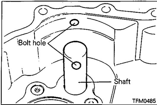
**⇨F⇨ REVERSE IDLER GEAR SHAFT INSTALLATION**
